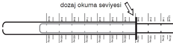
2. Reçeteye yazılan doza karşılık gelen sınıra (ml veya mg olarak) ulaşmaya kadar pistonu yukarı doğru çekiniz. Gerekliğinde işlemi tekrarlayınız.
